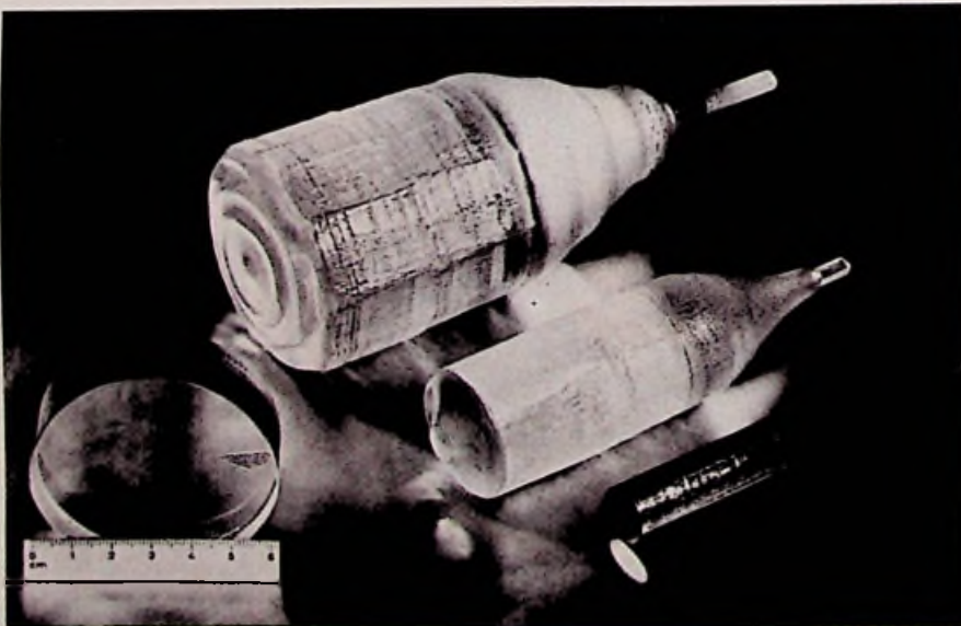
Bild 1. Riesenkristalle von Gadolinium-Gallium-Granat, gezüchtet nach einem automatisierten Czochralski-Verfahren, das im Philips Forschungslaboratorium Hamburg entwickelt wurde.
