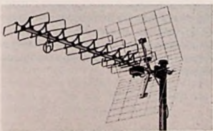
Bild 13.02. Montage einer kurzen UHF-Antenne
